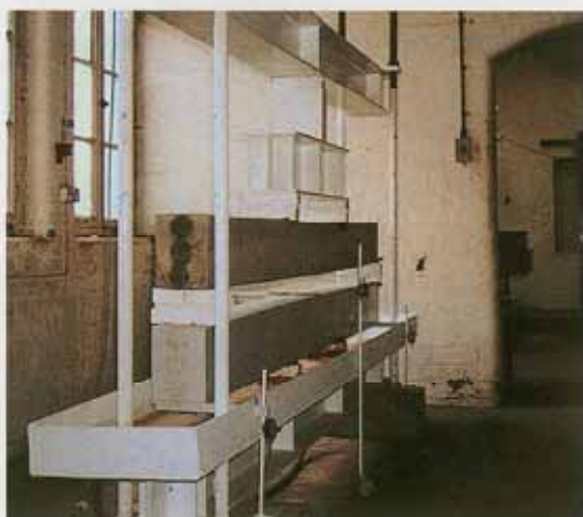
持続載荷試験状況
