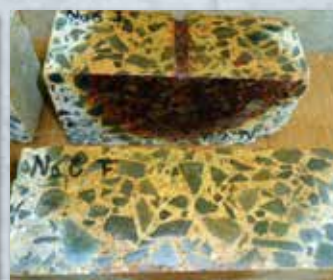
カプセル式内部圧入工法による亜硝酸リチウム浸透状況(呈色反応試験) (茶褐色の変色範囲に亜硝酸リチウムが浸透していることを示す)
