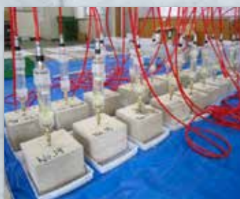
カプセル式内部圧入工法の実験状況
