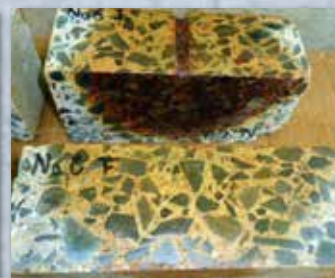
カプセル式内部圧入工法による亜硝酸リチウム浸透状況(呈色反応試験) (茶褐色の変色範囲に亜硝酸リチウムが浸透していることを示す)
