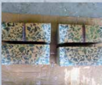
カプセル式内部圧入工法による亜硝酸リチウム浸透状況(呈色反応試験) (茶褐色の変色範囲に亜硝酸リチウムが浸透していることを示す)
