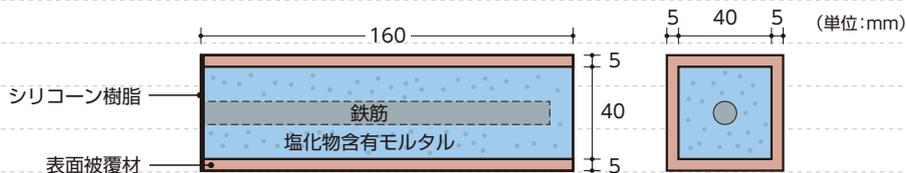
表面被覆材 …… A:被覆無し B:ポリマーセメントモルタル5mm(SBR系) C:RVモルタル5mm
