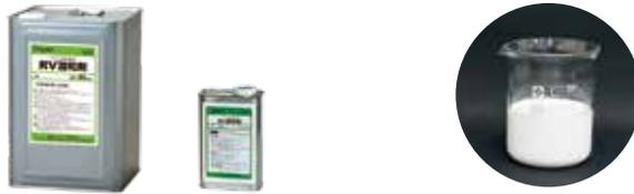
特殊ゴムラテックス(SBR)に亜硝酸リチウムを高濃度に添加したエマルジョンです。(亜硝酸リチウム16% SBR16%含有)RVパウダー類と混練し、亜硝酸リチウム含有ポリマーセメントペースト/モルタルを作ります。また、2倍希釈してRVモルタル断面のプライマーとしても用います。
