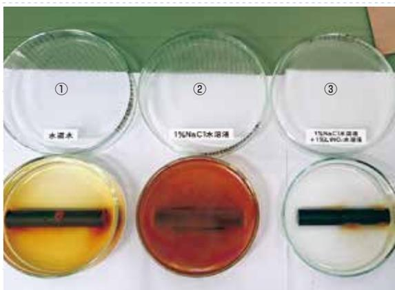
7日目を比較すると、1%食塩水のみ鉄棒片発錆状態②と比べ、亜硝酸リチウムを加えた③は明らかに発錆量が抑えられていることが確認できます。
