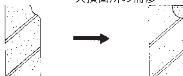
欠損箇所の補修
