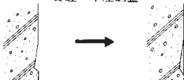
ひび割れの補修
