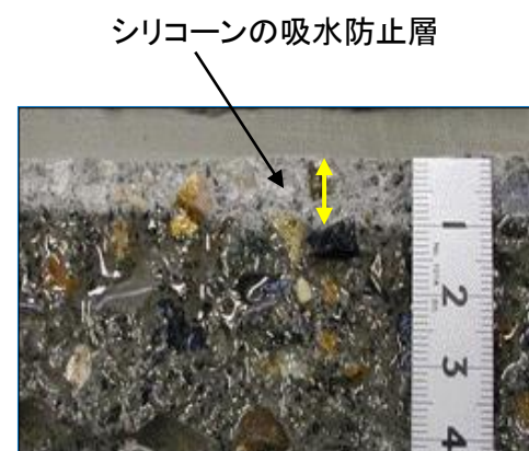
パブリック®リペラーの浸透深さの一例 (割裂後の断面写真)
