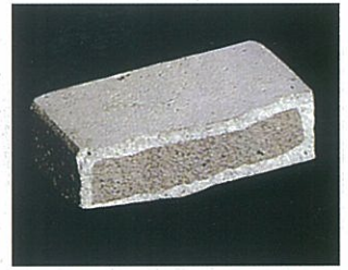
モルタル下地への浸透効果
