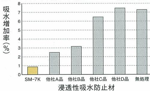
7×7×2cmの1-2モルタルに材料を300g/m<sup>2</sup>塗布し、7日間室温にて養生後、飽和水酸化カルシウム溶液に全面浸漬し、7日後の吸水増加量を測定した。
