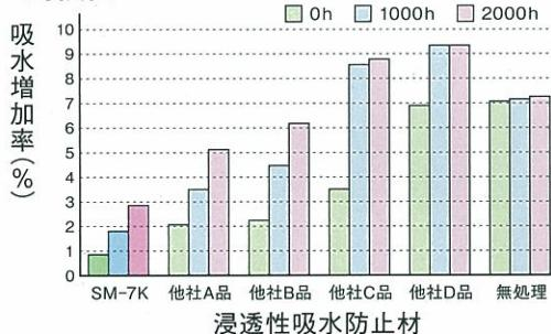
7×7×2cmの1-2モルタルに材料を300g/m<sup>2</sup>塗布し、7日間室温にて養生後、促進耐候試験機で紫外線を1000時間、2000時間照射し、水中に浸漬して吸水増加量を測定し、初期の吸水率と比較を行った。
