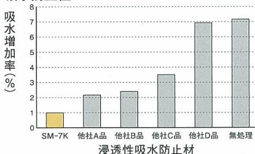
7×7×2cmの1-2モルタルに材料を300g/m<sup>2</sup>塗布し、7日間室温にて養生後、水道水中に全面浸漬し、7日後の吸水増加量を測定した。吸水増加率は、次の計算により求めた。
